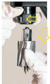
Facilidade em substituir a broca pelo sistema único de troca rápida
