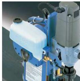
Líquido refrigerador é despejado diretamente no interior do corte, e também possui um sistema de desligamento automático
